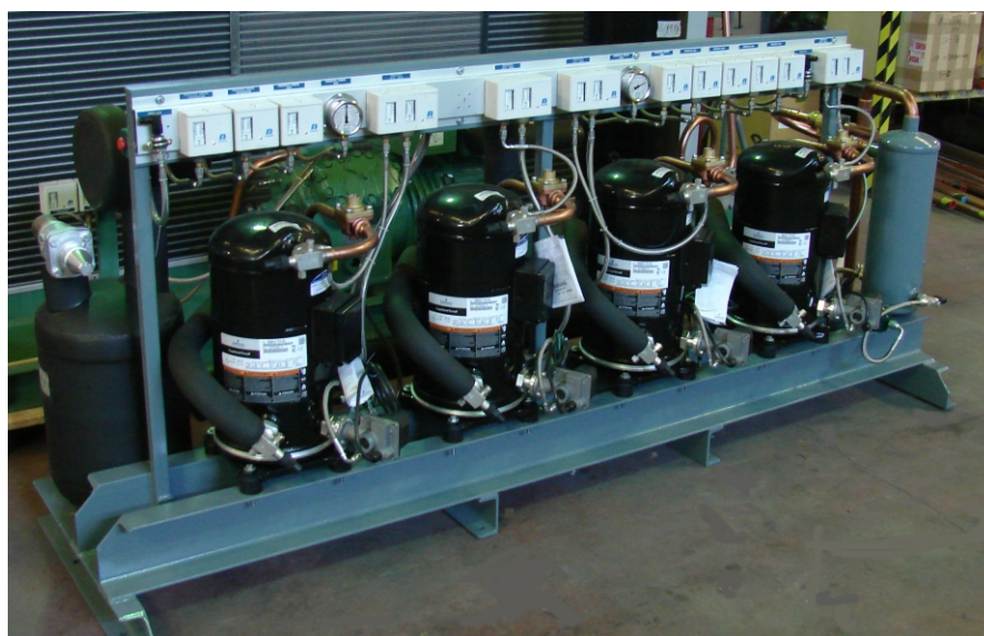
CENTRAL DE 4 COMPRESORES SCROLL COPELAND ACP 4 X ZR22K3E-TFD. ( 5°C/ +45°C) R 134A. Pot. frigorífica = 14 kW
