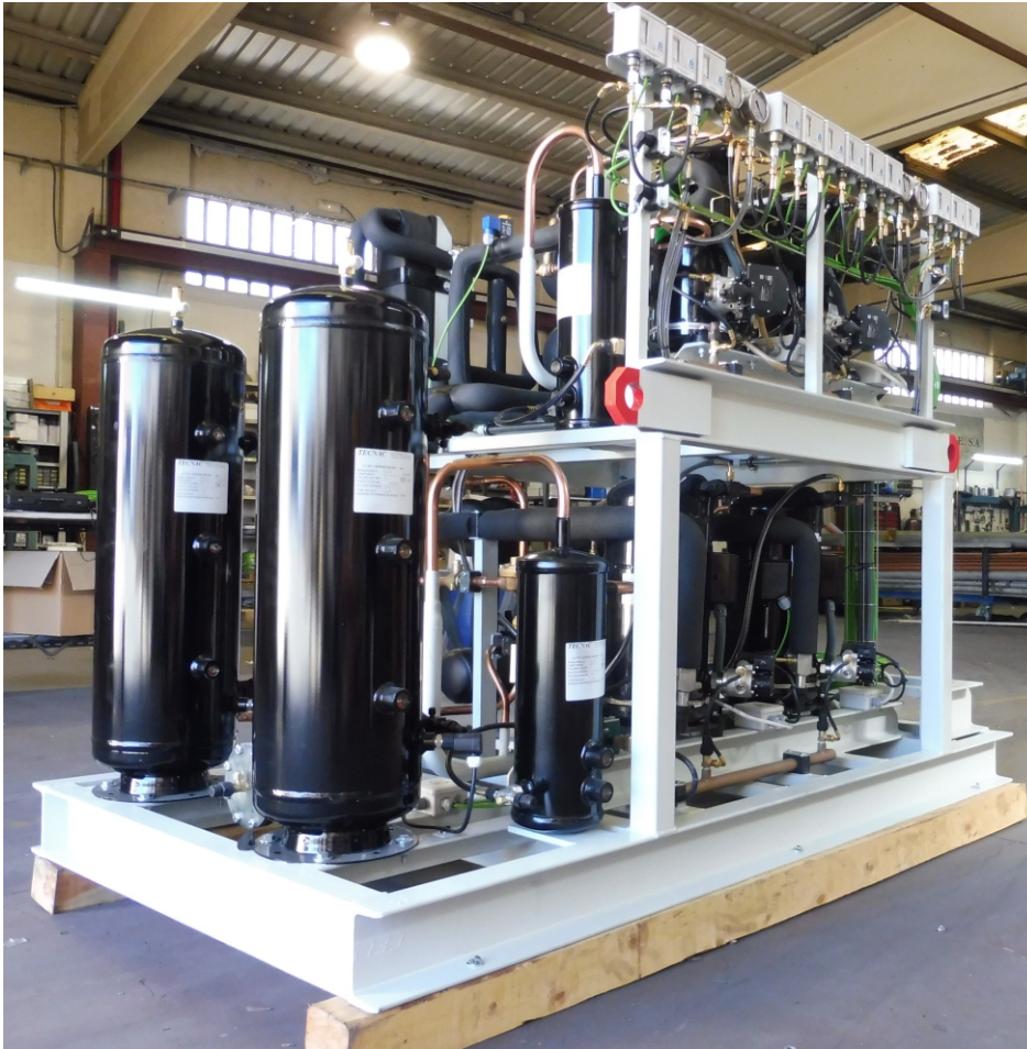
2 CENTRALES EN LA MISMA BANCADA DE DOS ALTURAS CON COMPRESORES SCROLL COPELAND
