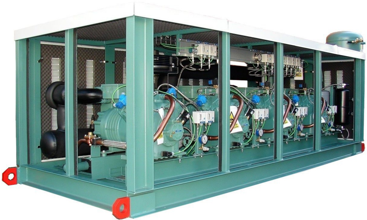
CENTRAL CARROZADA E INSONORIZADA CON 4 COMPRESORES BITZER ACP 4 X 4GE-23Y. (-10°C/ +45°C) R 449A. Pot. frigorífica = 170kW
