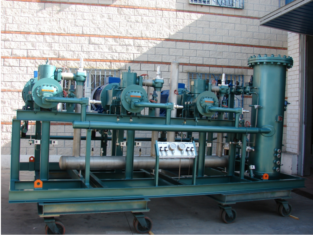
CENTRAL DE NH3 DE 3 COMPRESORES MYCOM SERIE I
