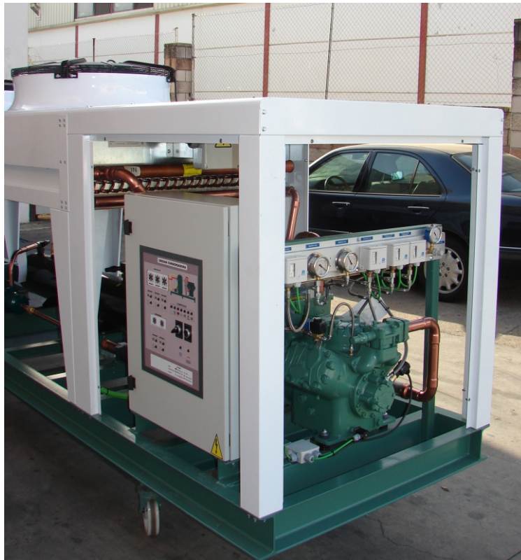
ARRIBA: UNIDAD CONDENSADORA TIPO ROOFTOP CARROZADA, SISTEMA DE FUNCIONAMIENTO ABATIDOR. CON COMPRESOR BITZER Y CUADRO ELÉCTRICO MONTADO EN BANCADA. ABAJO: DETALLE DEL CARROZADO.
