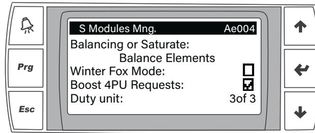
Dans le cas d'exemple, tous les modules qui constituent le système modulaire peuvent être appelés en fonction si la charge thermique le demande. En revanche, en paramétrant « Duty unit: 2 of 3 », au maximum 2 des 3 modules constituant le système pourraient travailler simultanément.
