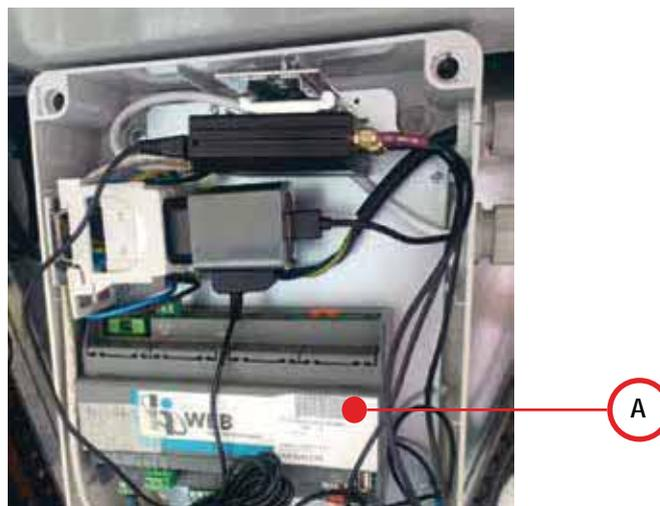
3. Fixer l'antenne externe au panneau latéral en ouvrant le pré-clip en tôle (A) et connectez les 3 câbles (LTE MAIN, LTE AUX et WI-FI MAIN) de l'antenne (B) au routeur (C) comme indiqué sur les images.
