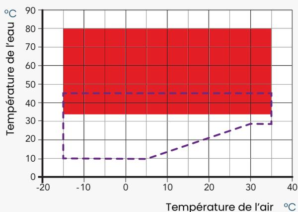
■ Mode chauffage - Sortie d'eau
